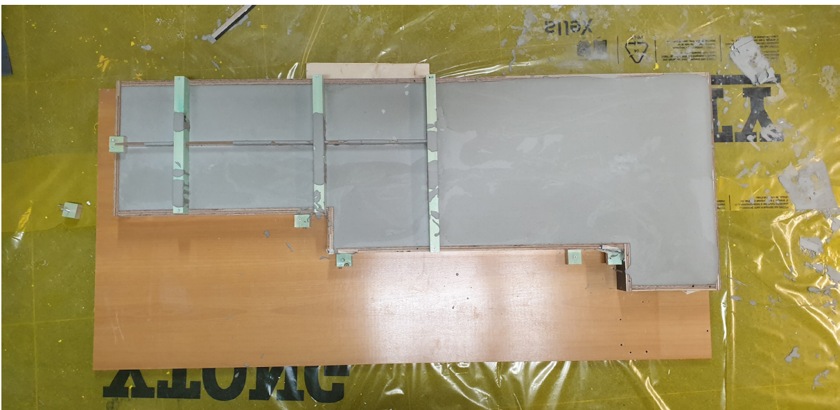
Vezelversterkte egalisé gieten van sokkel
